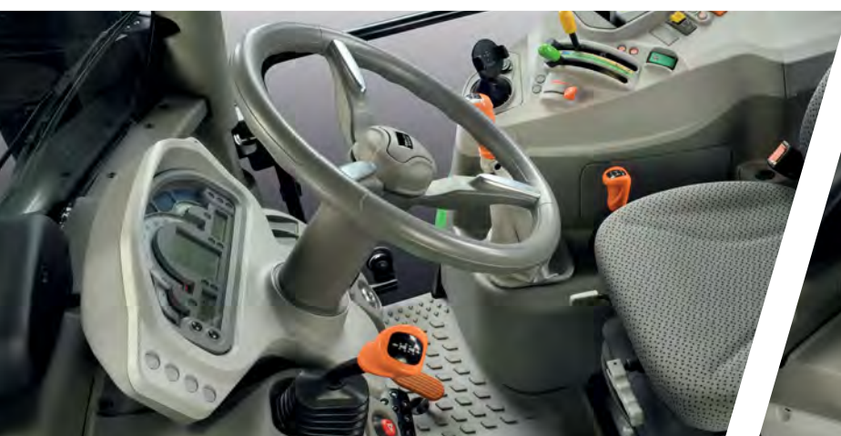
> Mechanický prehadzovač s ergonomickou pákou na stĺpiku riadení.
