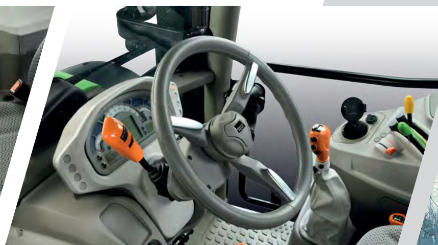
> PowerShuttle s 5-úrovňovým nastavením SenseClutch a funkciou Stop&Go.
