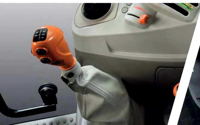
> Ergonomická radiacia páka s ovládaním prevodovky Powershift a spojkou ComfortClutch.
