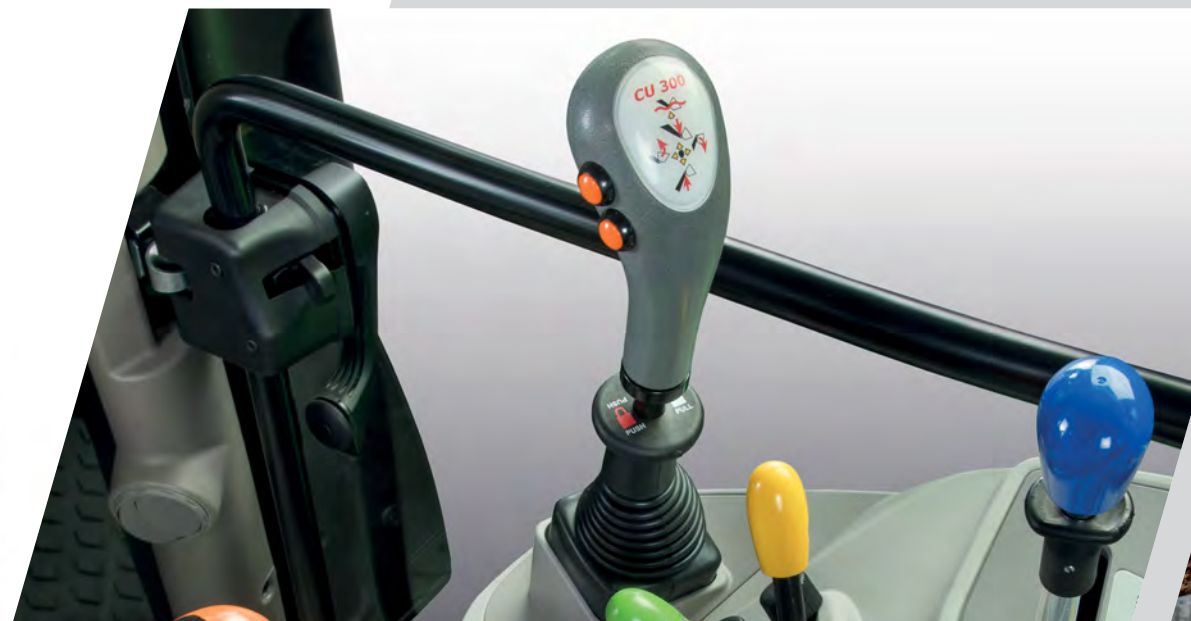
> Joystick s ovládaním Powershift pre ľahký pohyb čelného nakladača.
