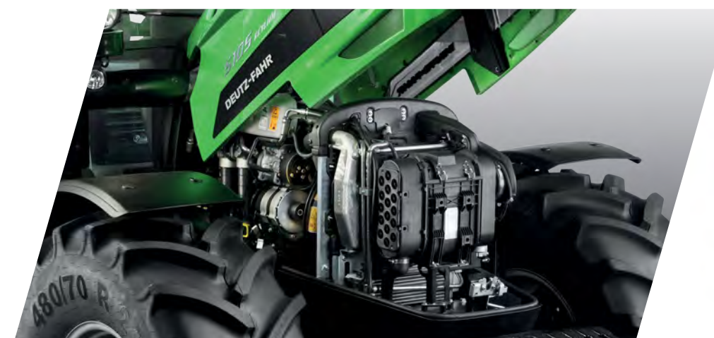
> Motor FARMotion 45 s výkonom od 75 do 106 HP s alebo bez SCR.
