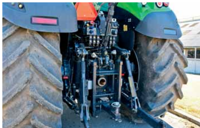
Zadná časť traktora s maximálne 6 okruhmi hydrauliky a čerpadlom s výkonnosťou 210 l za minútu. Obsluha pre minimalizáciu ušpinenia tejto časti stroja od kolies traktora vymyslela vnútorné „blatníky“. Pochválme aj praktický držiak tretieho bodu závesu.
