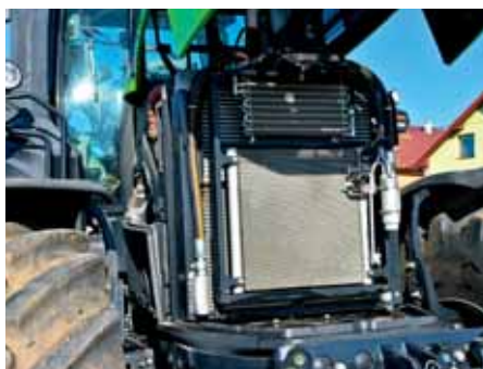
Výborný prístup k motorovej časti je cez elektricky ovládateľnú kapotu.
