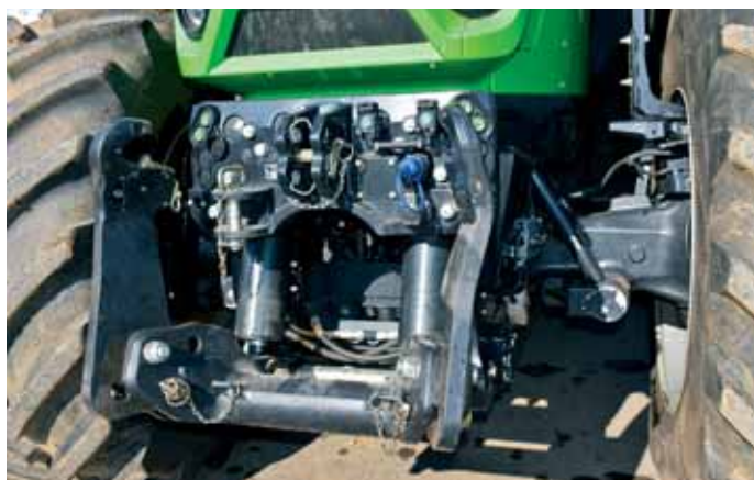
Predná náprava má šikmé tlmiče a stabilizáciu automaticky aktivovanú od 30 km za hodinu. Predný záves udržiava 5 ton, k dispozícii sú aj dva okruhy hydrauliky. Chýba ešte vývodový hriadel s 1000 a 1000E otáčkami.
