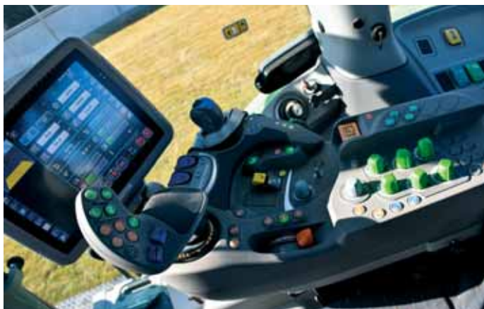
Veľký 32 cm displej možno rozdeliť na štyri okná. Joystickom Max-Com sa riadia mnohé funkcie, tlačidlá sú rozlíšené aj farebne.
